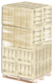
Упаковка «Мультипак» («МУЛ») Единичные упаковки компрессионно сжимаются и упаковываются в полиэтиленовую пленку, формируя модули. Затем модули укладываются на деревянный поддон и обматываются стрейч-пленкой.
